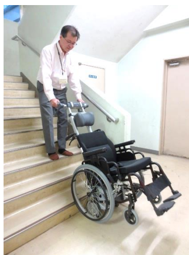
学校へ配備した階段昇降機
